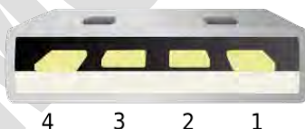
Рисунок 55 – Разъем USB тип А.
