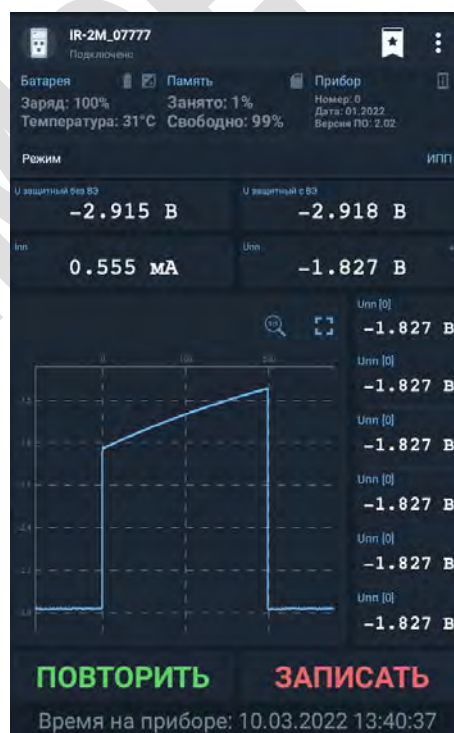
Рисунок 23 – Измеренные значения в режиме «ИПП»
