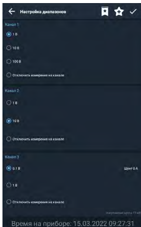
Рисунок 17 – Настройка пределов измерений
